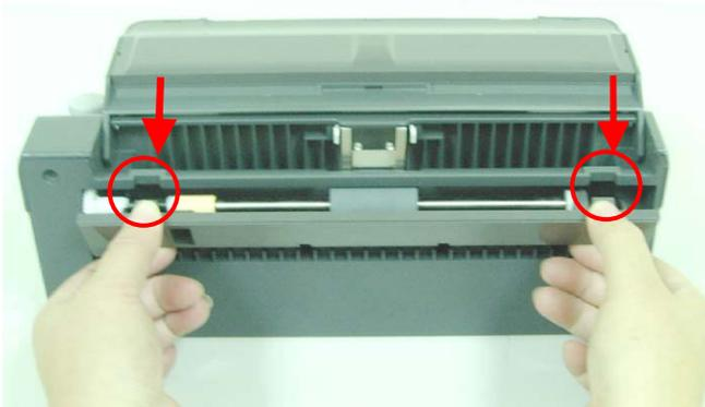
6. Usare le dita per tenere premuti i due lati del modulo di protezione per rimuoverlo.
