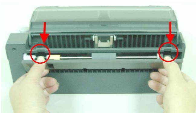
3. Pulire il rullo ADF ed il modulo di protezione ADF usando un panno morbido e senza peluria inumidito con dell'alcol isopropilico (95%). Evitare di toccare le parti metalli che quando si pulisce il modulo di protezione ADF.
