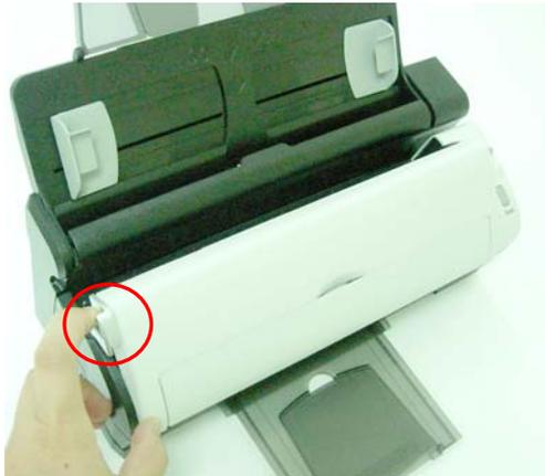
2. Pulire i rulli usando un panno morbido e senza peluria inumidito con dell'alcol isopropilico. (95%). Evitare di toccare il braccio del sensore mentre si puliscono i rulli.
