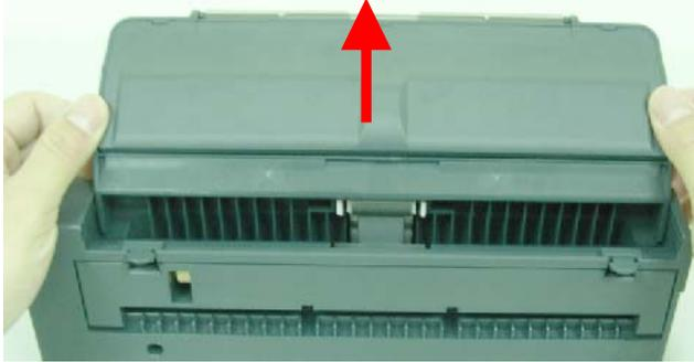
5. Premere i due fermagli sulla parte posteriore del modulo d'alimentazione automatica dei documenti per aprire la copertura posteriore.
