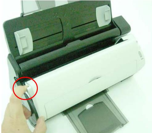
2. Pulire il vetri usando un panno morbido e senza peluria inumidito con dell'alcol isopropilico. (95%).
